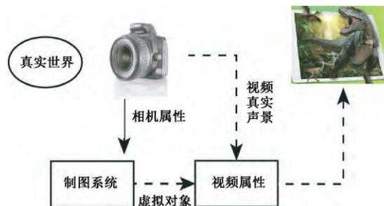
图2 Monitor-Based增强现实系统实现方案
