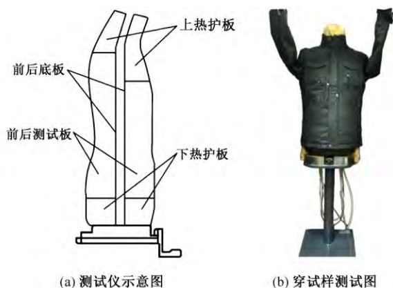
图2 新型服装保温性能测试仪假体及穿上试样测试情况
